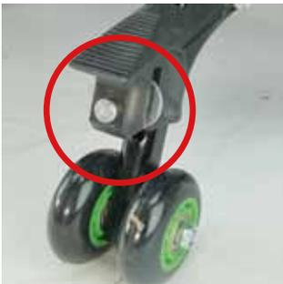
丸部分の金具を手前に引くことにより、転倒防止キャスターの高さ調整が出来ます。※乗車前にフロント部を持ち上げ転倒防止装置が地面に設置し、車椅子が後方転倒しないことを必ず確認してください。
