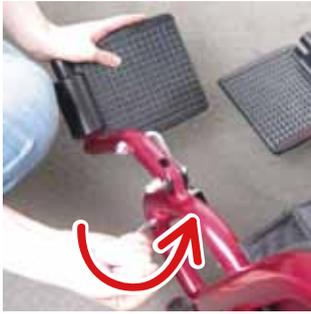
フットレストを下げる場合は、片手でレバーを持ち上げた状態を維持し、もう片方の手でフットレストを下げます。下がりにくい場合はフットレストを上下に動かしながらレバーを持ち上げると動きます。
