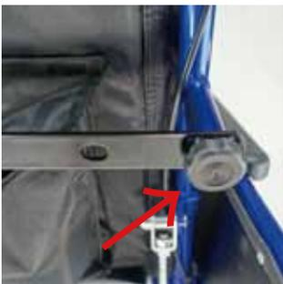
矢印部分を時計回りに動かすと締まります。また反時計回りに動かすと緩みます。※ご使用時は安全の為、必ず補強バーをお取り付けください。※折り畳みの際は補強バーを外してください。
