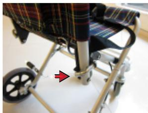
2. ハンドル部分を持ち上げL字金具をずらしバックレストが倒れないように固定する。
