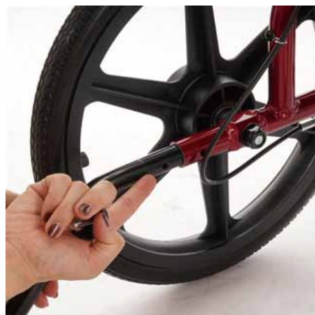
②転倒防止バーをフレームに差し込み固定金具で固定する。
