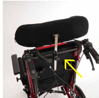
⑤ヘッドレストの高さ調整はノブを回してお好みの高さに固定してください。左回りで緩み、右回りで締め付けになります。
