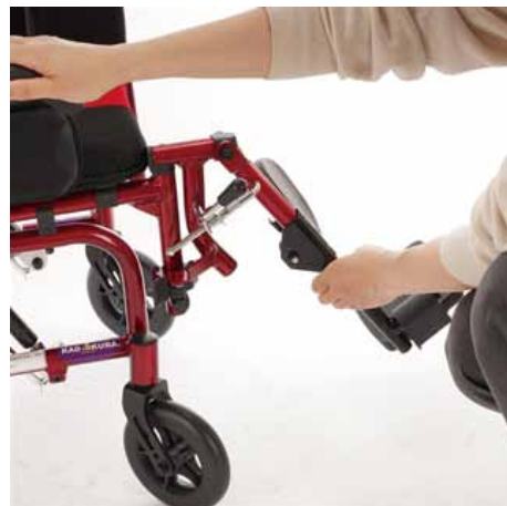
④フットレストを中央に引き寄せ垂直になるように固定する
