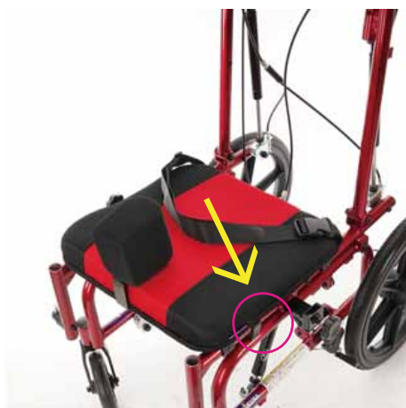
④座面ベースがフレームにしっかり入っているか確認する（背面シートを後で差し込む為、前方よりに取り付ける）
