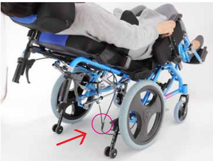
リクライニングさせた状態で移動する場合は作動ケーブルを地面に引きずらないように注意すること。
