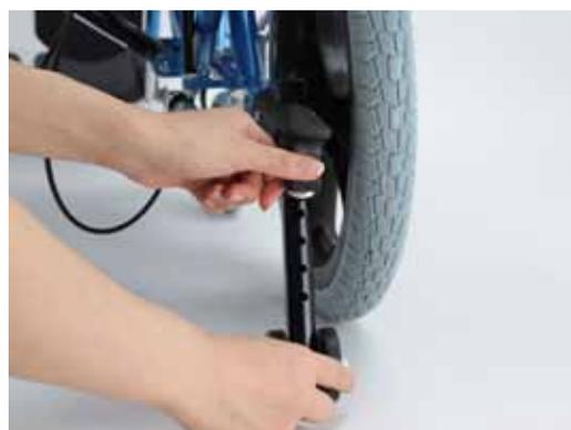
②ストッパー金具を引き上げて転倒防止バーを地面ギリギリで調節。
