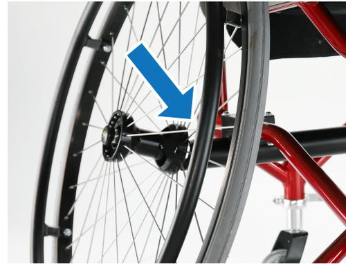
左の図のように①ボスがフレーム奥まで入っている場合、タイヤに装着されている③シャフトがフレーム内部に接触しタイヤがスムーズに回転しないことや、きちんとはまらず抜けてしまうことがあります。
